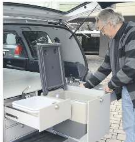
Das bei VanEssa in Deutschland gekaufte Grundmodul mit Gaskocher, Kühlschrank und Abwaschbecken.
