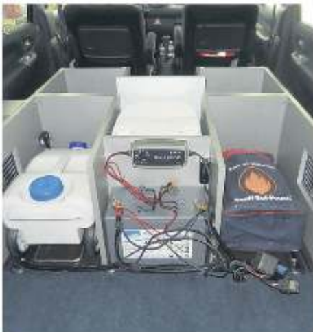
Zusatzmodule mit Zusatzwassertank und -batterie, WC in Fahrposition, Stauraum für Grill, Kleider usw.
